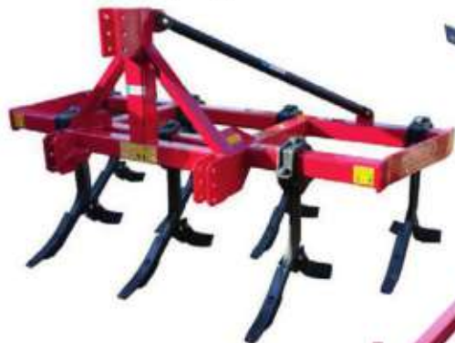
Ρίπερ υπεδαφοκαθλιέρυγης με φρεζομάχαιρα
