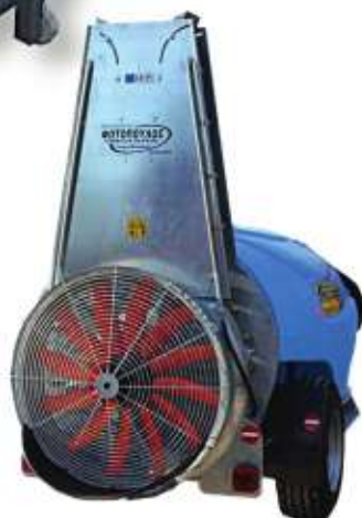
Ψεκαστικό με τουρμπίνα 2ton με πύργο ψεκασμού για παθμέτα
