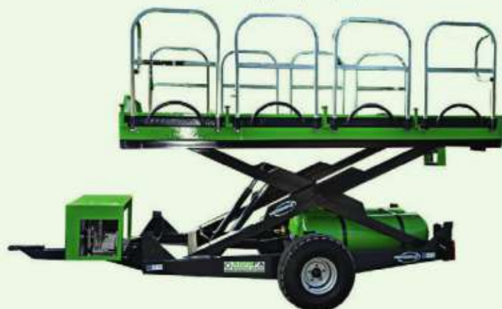
Υδραυλικές πλατφόρμες συγκομιδής με κλαδευτικό συγκρότημα αέρος SYK
